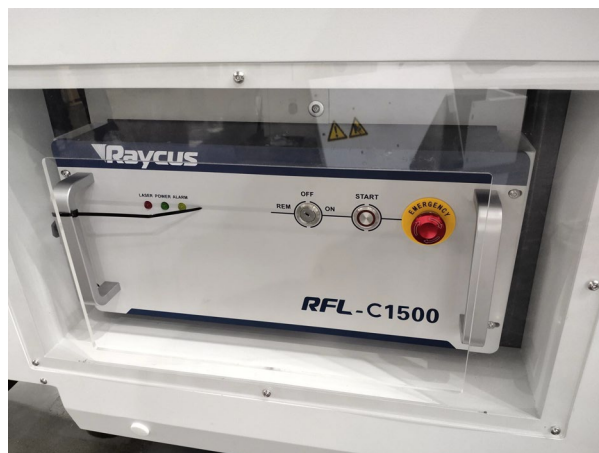
Кнопка аварийного останова на лазерном источнике излучения
