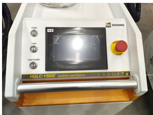
Кнопка аварийного останова на панели управления
