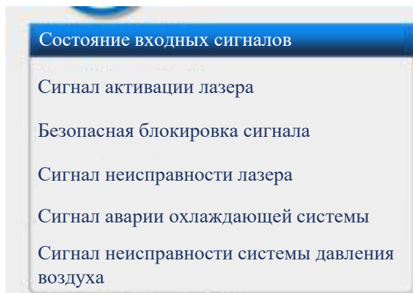
Рисунок 5.25 — Страница мониторинга — Индикатор состояния входных сигналов
