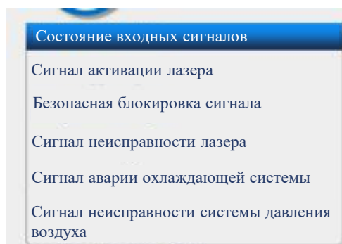
Рисунок 5.9 — Индикатор состояния входных сигналов
